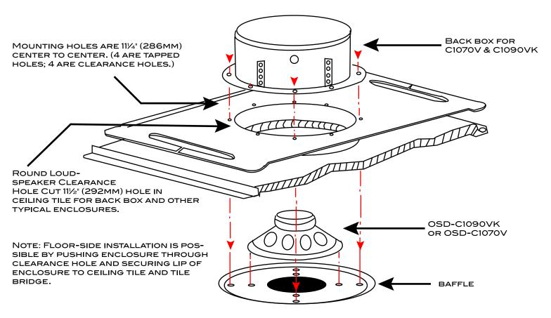
THE BACK BOX DOES NOT INCLUDE SLOTS FOR MOUNTING TORSION SPRING GRILLES.
